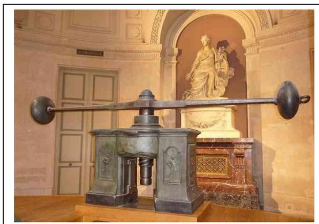
qui permettent son approche en ¼ de tour. 3 filetages nécessitent 1/3 de tour, 2 filetages en ½ tour. Les manivelles horizontales qui entraînent l'axe dans sa rotation mesurent 1,5m environ, et sont lancées, à la main, par plusieurs ouvriers munis de cordes attachées aux extrémités. Etant donné la masse de l'engin et la violence du geste la pression exercée sur le flan est très importante.
